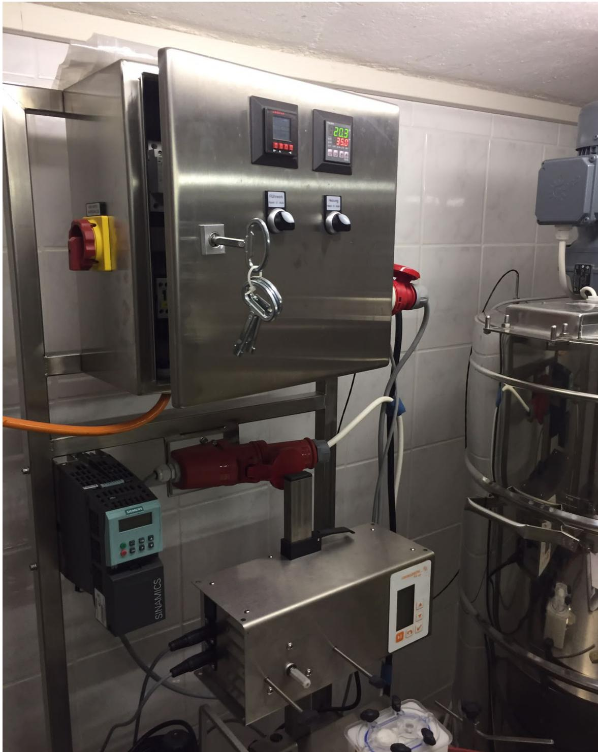
**Oben: Schaltkasten - Bedienfront mit digitaler Temperaturregelung, Zeitschaltuhr für max. 60 Programme, Hand- und Auto Steuerung**
